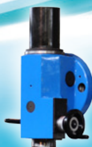
Głowica J2 z mech.-hydraulicznym mocowaniem narzędzia
